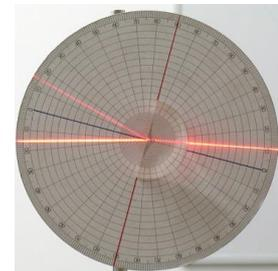
Dove  $n_p$  è l'indice di rifrazione della plastica e  $n_a$  è l'indice di rifrazione dell'aria che è quasi uguale a 1. Per verificare la legge ruotare il goniometro in modo che la luce incida sulla faccia piana del semicilindro e l'angolo di incidenza abbia i valori in tabella; quindi misurate gli angoli di rifrazione e calcolate il rapporto nei tre casi. Il rapporto dovrebbe essere sempre lo stesso entro degli errori (sapreste calcolarli?)
